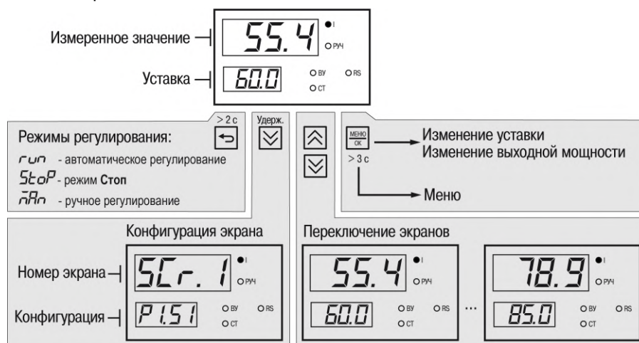
Рисунок 6.5 – Схема переходов с главного экрана
